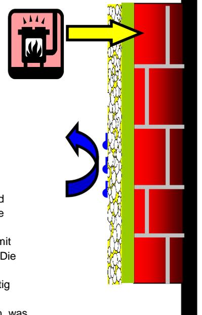
Die Oberflächentemperatur der Wände erhöht sich um bis zu 3°C
